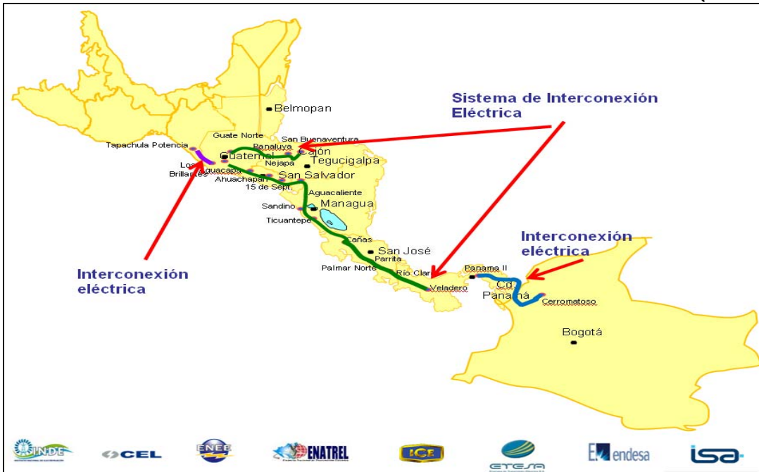
GRAFICO 3 SISTEMA DE INTERCONEXIÓN ELÉCTRICA PARA LOS PAÍSES DE AMÉRICA CENTRAL (SIEPAC)
